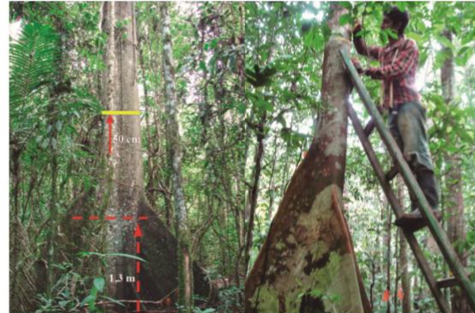
Figura 11. Medición del diámetro en árboles con bambas o aletones. La línea amarilla indica el punto óptimo de medición, en algunos casos es necesario utilizar escaleras.
