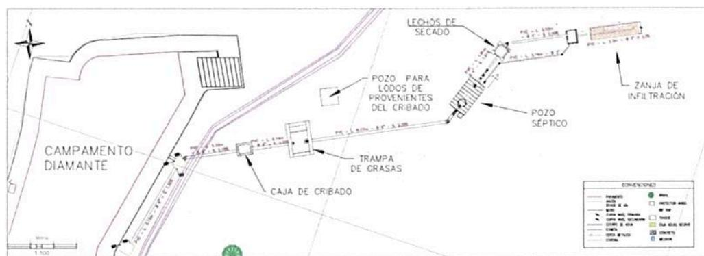
Plano del Sistema de Tratamiento de Aguas Residuales. Fuente: EAAB ESP
