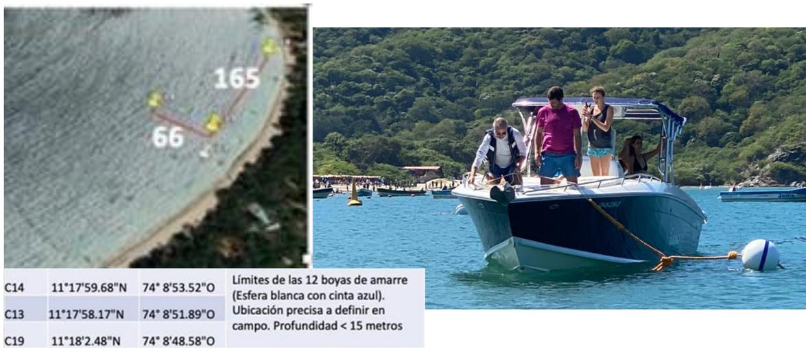
*Figura 50. Sistema de amarre de embarcaciones instalado en la zona Norte de la Playa Principal de Bahía Concha – PNNT.*
