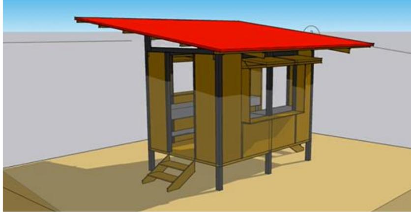
*Figura 43. Diseño unidad desmontable y reubicable para la producción de alimentos en la Bahía Gayraca – PNNT*
