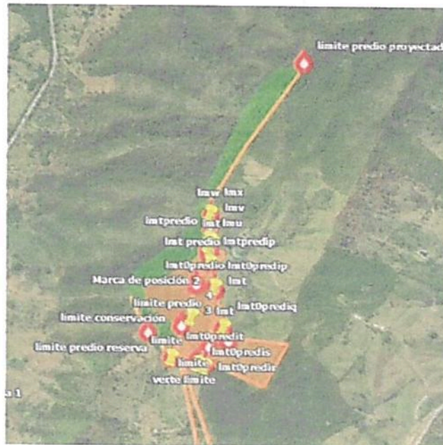
Figura 4. Puntos georreferenciados con el equipo de precisión GNSS CHC i90 PRO y recorrido realizado en la RNSC "LOS COLORADOS" en el marco del seguimiento. Fuente: Información suministrada por el propietario de la reserva y visita técnica realizada por PNNC el 09/10/2023
